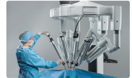
▲内視鏡手術支援ロボット インテュイティブサージカル製 Da Vinci Xi
