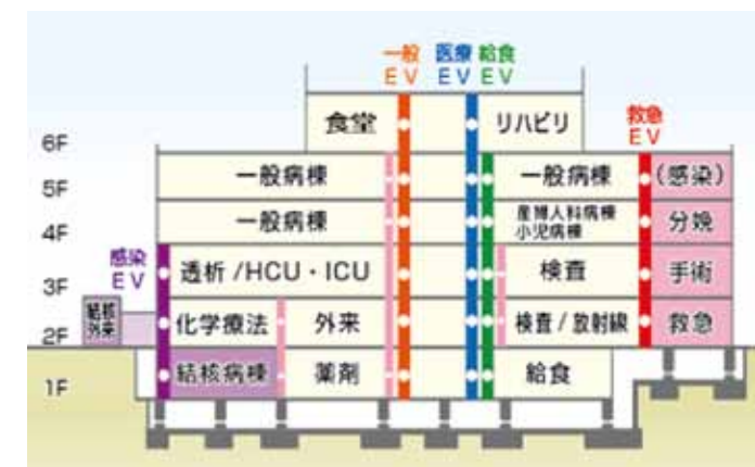
鉄骨造・6階建（免震構造）
